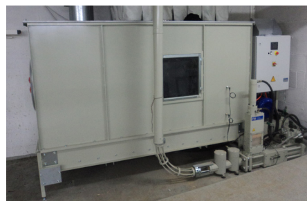
FVB250 mit Schubboden FDK, nachrüstbar für eine zweite Brikettierpresse und Förderschnecke.
